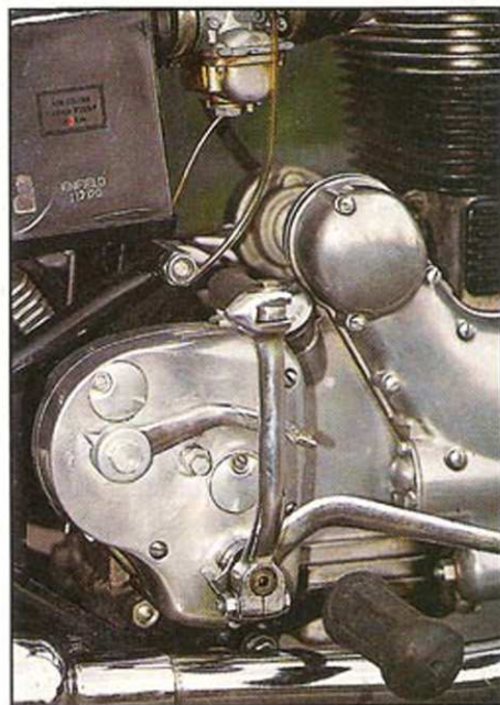
Sur le carter de boîte notez la pédale qui permet de revenir facilement au point mort
