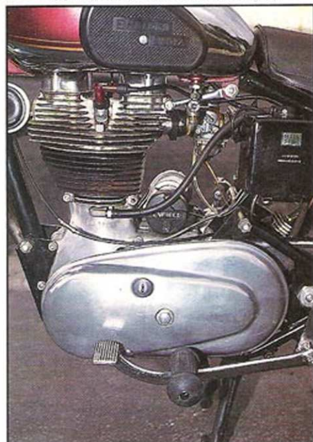
Facile pour bricoler et toutefois étanche le carter primaire est fixé par un seul boulon
