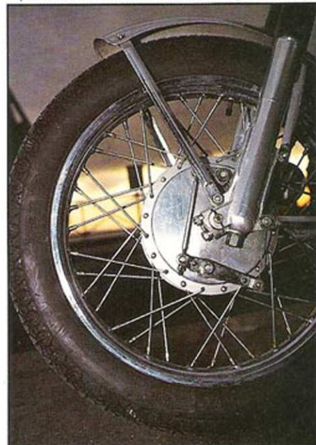
Un double came comme dans le temps passé. Surprenant à l'usage mais efficace
