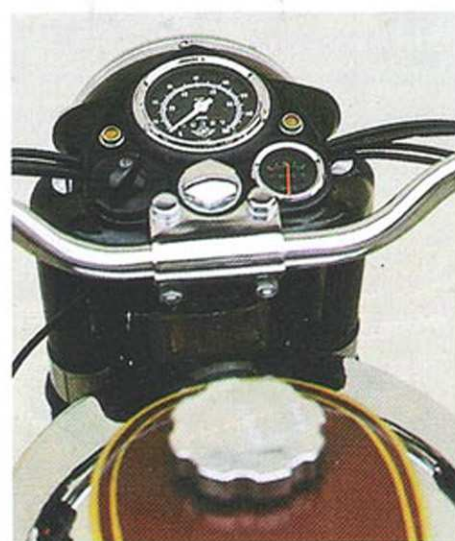
● Le petit cadran qu'on aperçoit sous le compteur de l'Enfield a deux fonctions. D'ampère-mètre, il devient témoin de compression lorsqu'on actionne le kick.
