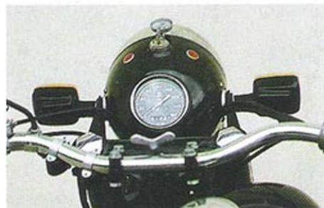
● Le tableau de bord de la Black Star est réduit à sa plus simple expression. Compteur de vitesse, voyants de contact et de lumière, un point c'est tout.
