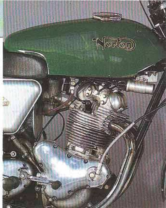
Le moteur de la Commando est très puissant malgré sa conception ancienne. Notez la boîte séparée et les carburateurs placés très haut sur la culasse.
