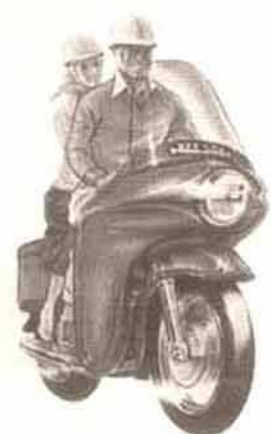
A partir de 1959, Royal Enfield proposait le carénage Airflow qui avait été étudié en soufflerie chez l'avionneur Bristol.
