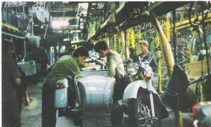
**Chaîne de montage des sides Ural, à l'usine d'Irbit. Lors de la fabrication, une différence est faite entre les machines destinées au marché intérieur et celles prévues pour l'exportation.**
