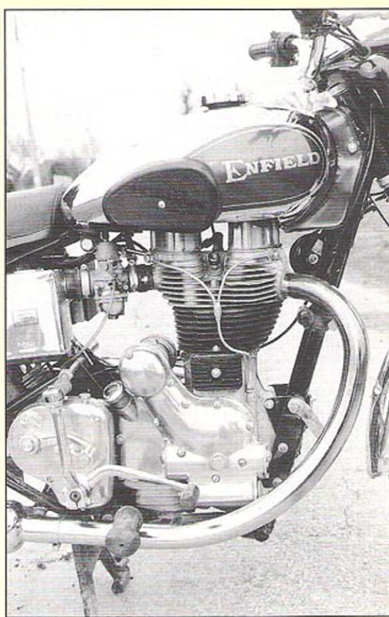
Un beau monocylindre anglais anime cette sympathique moto. Bien pratique : un second sélecteur qui permet de retrouver le point mort quel que soit le rapport engagé.
