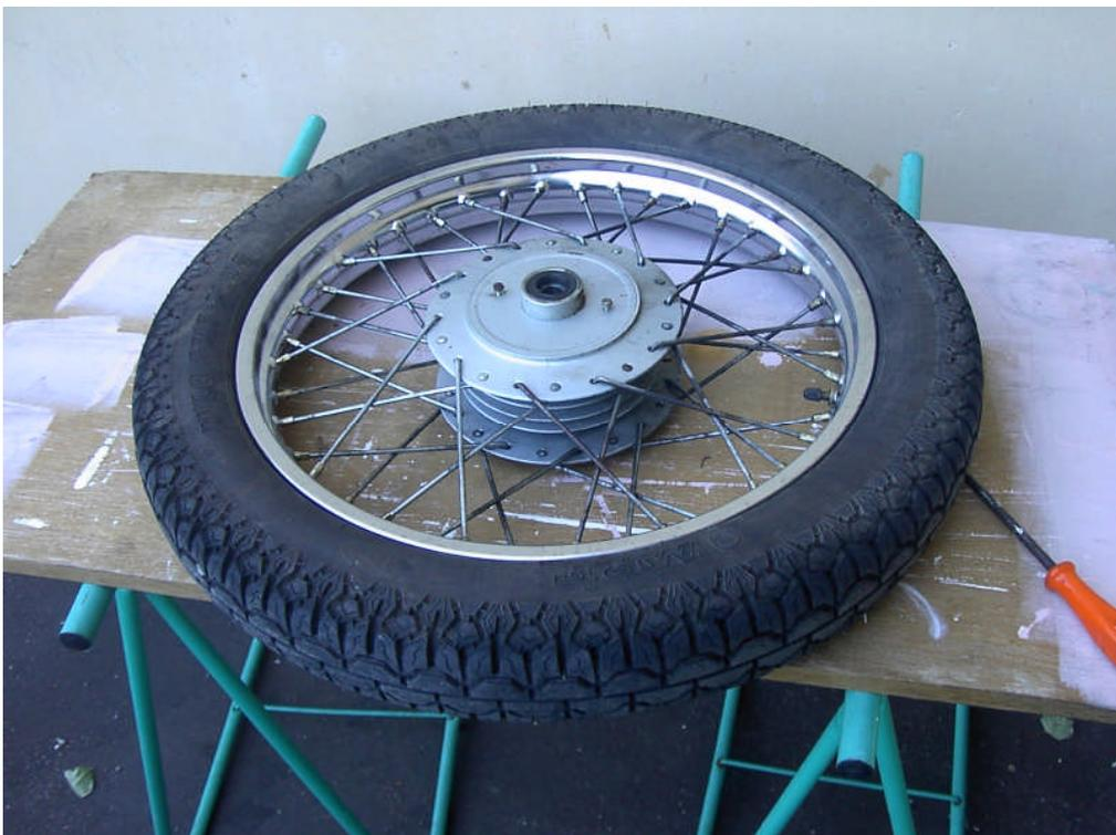
Sur le coté opposé à la flasque de frein, le roulement est protégé par un joint à lèvres. Deux solutions, soit le récupérer, soit en mettre un neuf.
