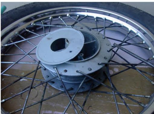
Dépose du **roulement et du joint à lèvres** coté droit en les chassant par des petits coups secs alternés depuis le coté chaîne.
