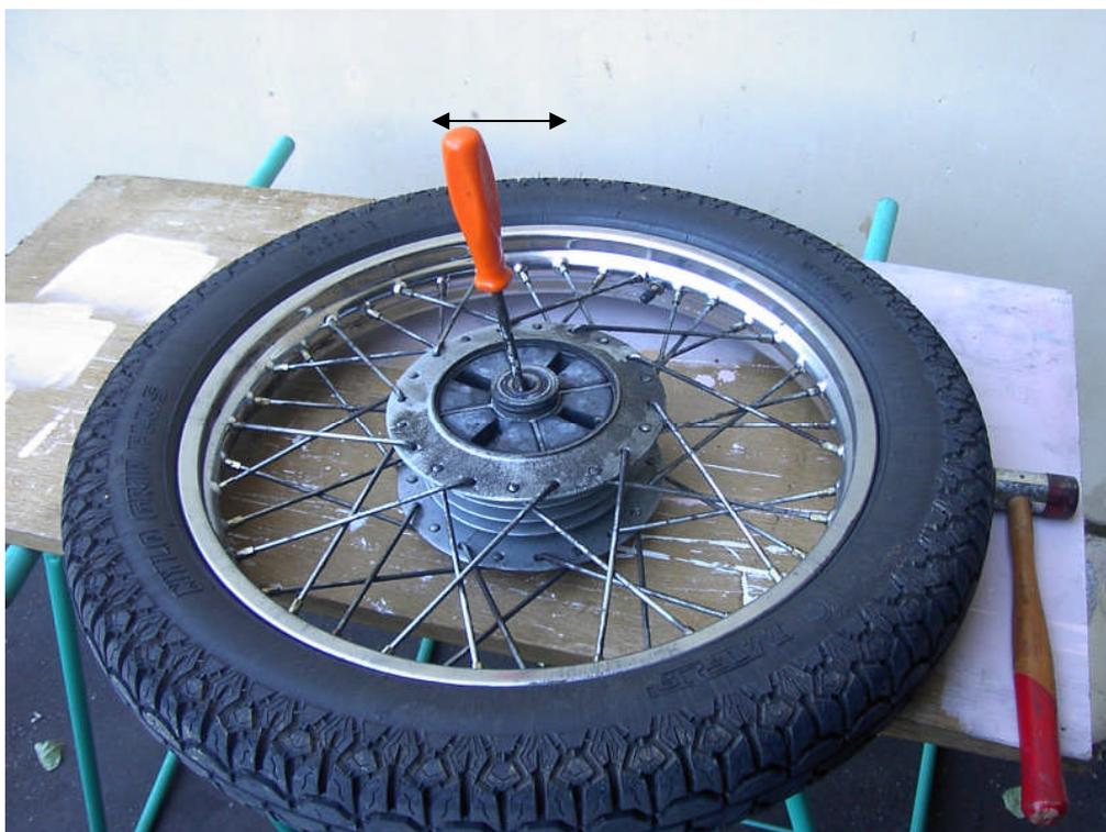
L'entretoise intérieure permet par des lumières opposées de prendre appui sur la cage du roulement, la poussée doit être progressive, alternée et régulière. (Inutile de taper comme un sourd).
