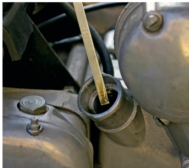
▲ Vidange et huile neuve dans le moteur avant l'hivernage. L'huile usée est corrosive.
