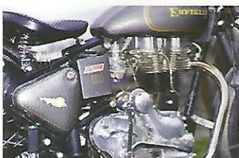
Un mono qui date du temps où on «sculptait» les moteurs. Le kick et le sélecteur sont implantés sur le même arbre. Le petit levier au dessus permet de récupérer directement le point mort.
