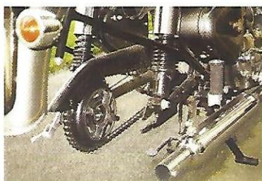
Mine de rien, en 56 on fabriquait des vraies roues à broche. En cas de démontage de la roue arrière on s'emmerde pas avec la chaîne qui reste sur la couronne. Simple et pratique. «Tu vois mon p'tit gars, les Japs y z'ont pas tout inventé !»
